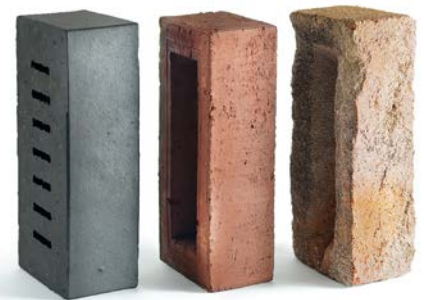
▲ Strangpress-, Wasserstrich-, Handformziegel
