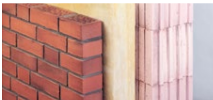
Prinzip Ausführung: Außenschale, Dämmung, Innenschale
