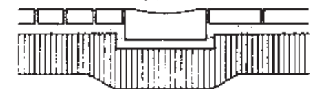
f) Mit Rinnenklinkern gepflasterte Rinne
