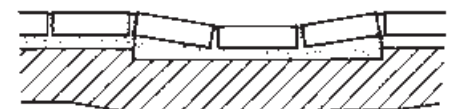
e) Pflasterung einer Rinne (Beispiel). Für die Verlegung der Klinker im Rinnenbereich ist eine Mörtelbettung (MV 1:3) erforderlich
